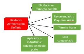
O Reator Aeróbios com Biofilme, este sistema possui um elevado custo de investimento de implantação e operação, possui baixo requerimento de energia e necessidade de operação por 24 horas por dia. Nesse sistema, a biomassa cresce aderida a um meio suporte. Podendo ser por filtro de baixa carga, filtro de alta carga, biofiltro
